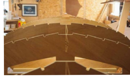
CNC-työstetty mallikkaat tuovat tarkkuutta rungon rakentamiseen ja sopeuttavat etenkin rakentamisen aloitusta. Valokuva: Mats Vuorenjuuri
